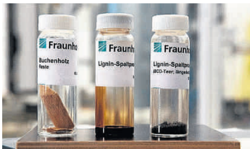
Holz ist der Ausgangsstoff (links). Es wird in eine flüssige Form umgewandelt, die soll dann für die Herstellung bestimmter Produkte genutzt werden.
